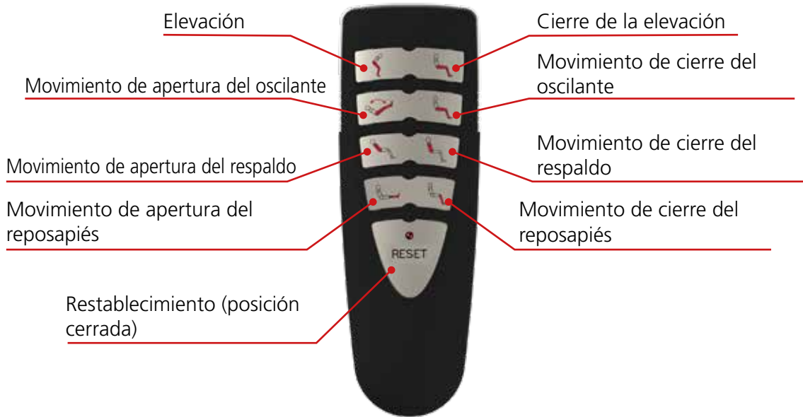
Figura 3: Ejemplo de mandos de la botonera del LIFT inalámbrica
