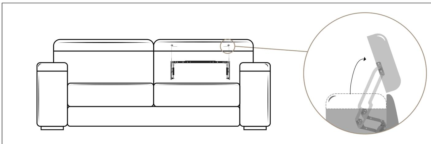
**Benefit:** Il poggiatesta manuale STILE hybrid è un prodotto versatile, caratterizzato da un ingombro ridotto grazie ad un sistema di regolazione telescopica della larghezza della barra trasversale. Caratteristiche: rotazione di 63°, alzata 191mm, traslazione 20mm.
