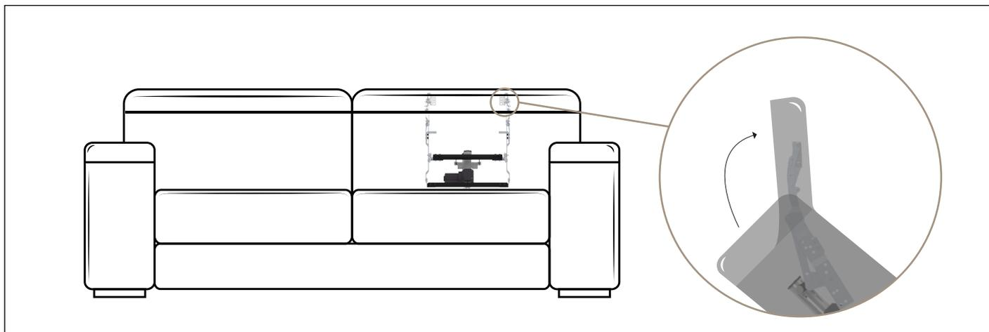
**Benefit:** Il poggiatesta elettrico è completamente foderato all'interno del divano, la struttura estremamente compatta ha le seguenti caratteristiche: rotazione 57°, alzata 54 mm, traslazione 105mm. L'alta qualità dei
