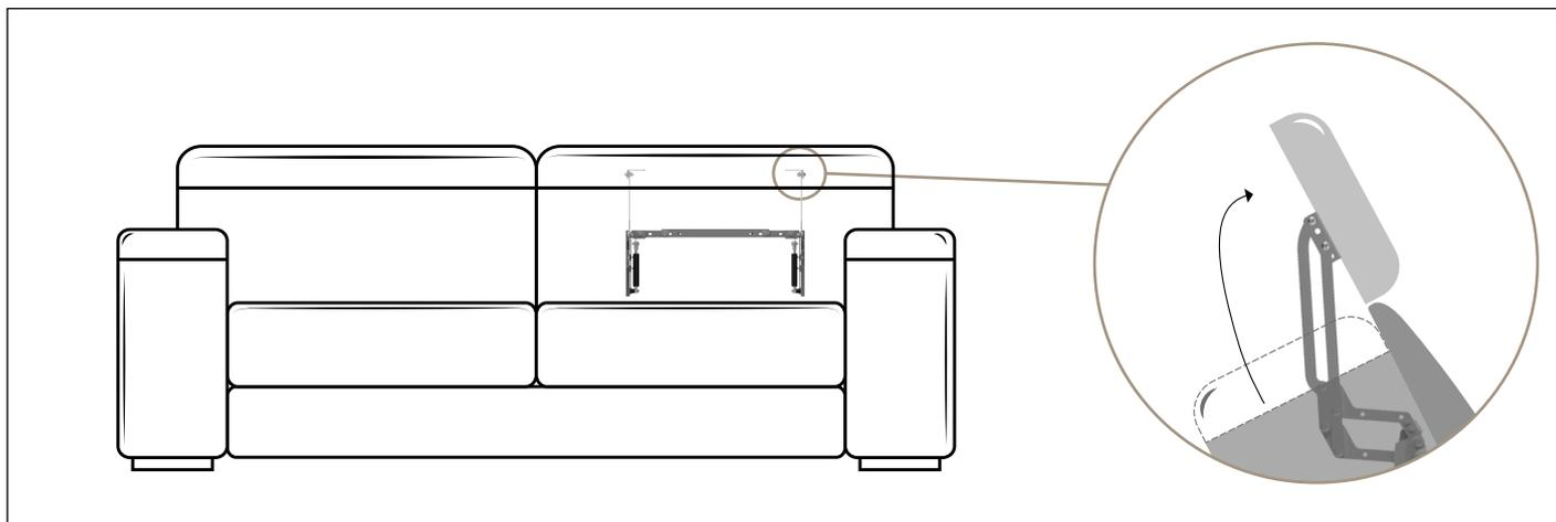
**Benefit:** Il poggiatesta manuale **STILE** è un prodotto versatile, caratterizzato da un ingombro ridotto grazie ad un sistema di regolazione telescopica della larghezza della barra trasversale (rotazione di 90°, alzata 241mm, traslazione 55,7mm). Offre un elevato livello di comfort
