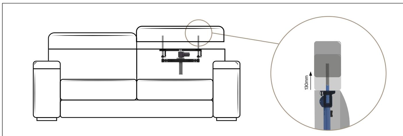
**Benefit:** VERTICAL fly motorized é un meccanismo motorizzato traslante, che consente di regolare l'altezza del poggiatesta a piacimento. Nuovo prodotto della famiglia VERTICAL, la versione fly è stata alleggerita e compattata, con un aumento della traslazione rispetto
